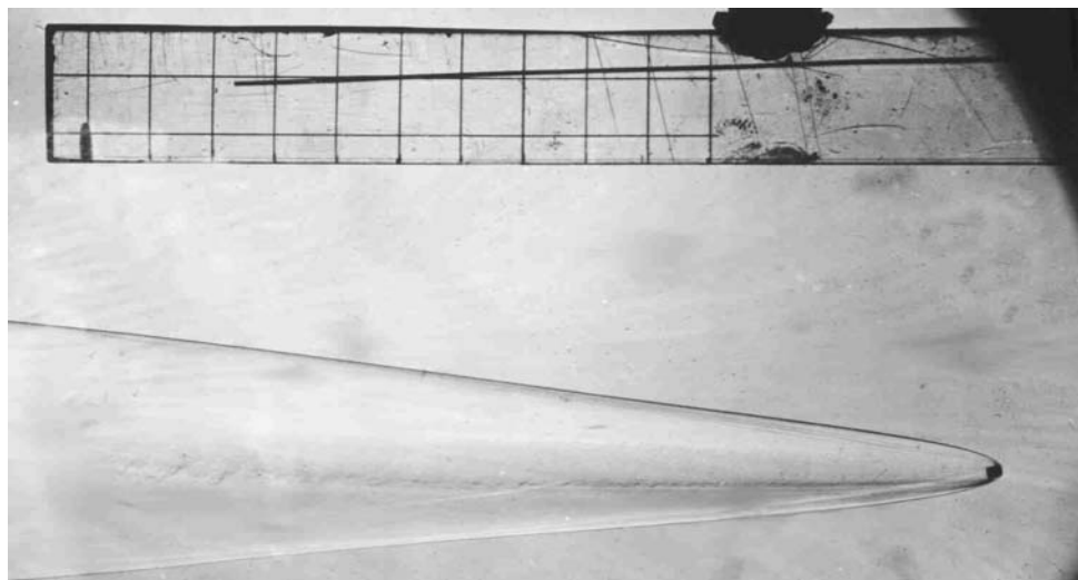
Рис. 1 - Теневая фотография полета ударника (2-мм кубик из поликарбоната) в атмосферном воздухе. Скорость - 5,7 км/с. Сторона масштабной сетки 10 мм. Время экспозиции 20 нс.
